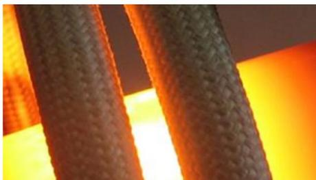
I **trattamenti termici** sono dei cicli termici di riscaldamento, effettuati in predeterminate condizioni e temperature, a cui devono seguire raffreddamenti (più o meno lenti), che hanno lo scopo di fare assumere all'acciaio una **struttura cristallina** che gli conferisce determinate **caratteristiche meccaniche**.
